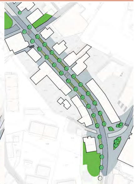
Variante 3: Schmalfahrbahn, Baumreihe beidseitig
